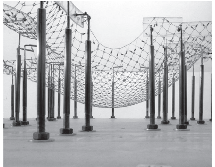
Frei Otto _Seifenhautmodell | Zug- und druckbelastete Konstruktionen | Hängemodell, 1960er Jahre
